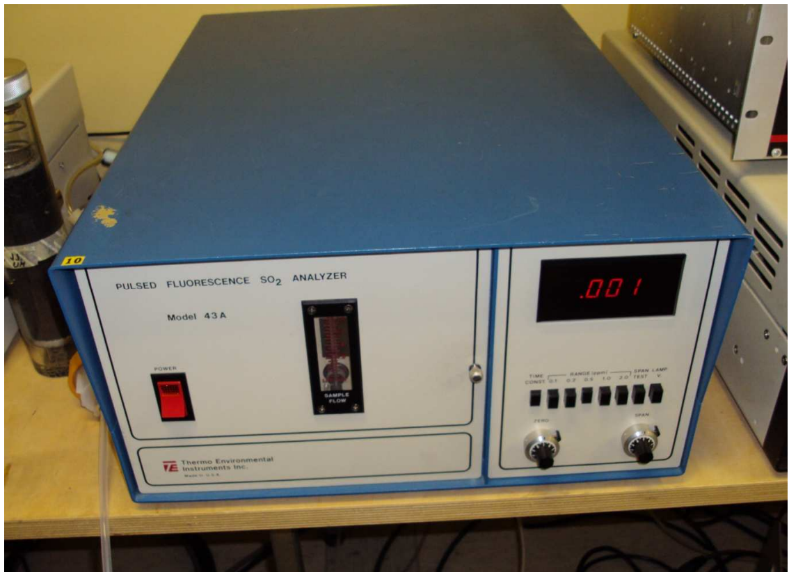
Kuva 2: Rikkidioksidin mittaus Hiskinmäellä tapahtuu Thermo Electron Model 43 A mittauslaitteella.
